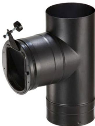
Lorsque le tirage est trop important, le registre s'ouvre, laissant entrer de l'air plus froid que les fumées dans le conduit, modifiant ainsi la pression juste au dessus de la buse de sortie. L'effet est alors un refroidissement des fumées et un ralentissement de leur évacuation.
