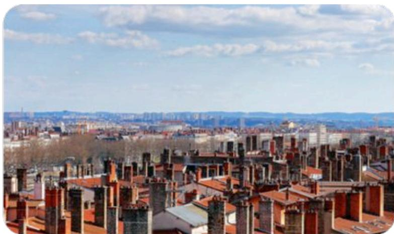
Le tirage thermique a lieu lorsqu'une différence de température engendre une différence de densité de l'air entre l'entrée et la sortie du conduit. Cet effet est accentué par une plus grande hauteur de cheminée.
